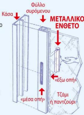
Τοποθετούμε το αντίκρουσμα (ΚΙΠΡΙ) της κλειδαριάς DOUBLEX, μέσα στην κάσα και απέναντι από το μέσον της παραλληλόγραμμης οπής. **Χρησιμοποιούμε τις πλαστικές προσθήκες για να φέρουμε το αντίκρουσμα πιο έξω (αν χρειάζεται).**
